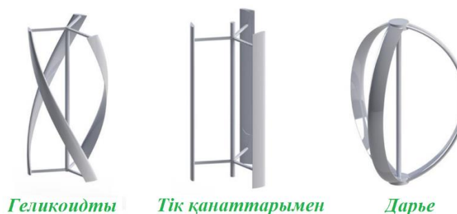
1.7-сурет – Ортогональды роторлар
