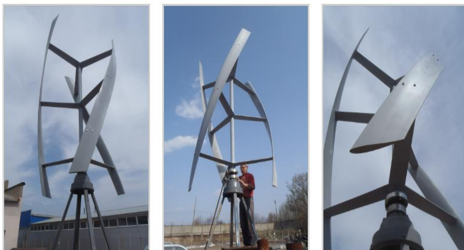
1.5-сурет – Геликоидты тік жел генераторы
